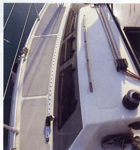
Gli inserti in gomma antisdrucciolo sono di eccellente tenuta anche sul bagnato. Da notare l'ampia finestratura della tuga, in parte apribile.
