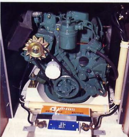
Al 18 cv Volvo Penta con trasmissione S Drive, si accede frontalmente e sul retro. Discutibile la posizione dell'unica batteria fornita di serie.
