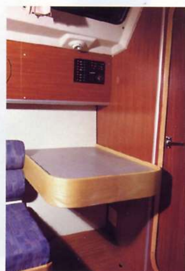
Il piano del carteggio, in laminato, misura cm 56x80 ed è studiato per fungere come tavolo da pozzetto.
